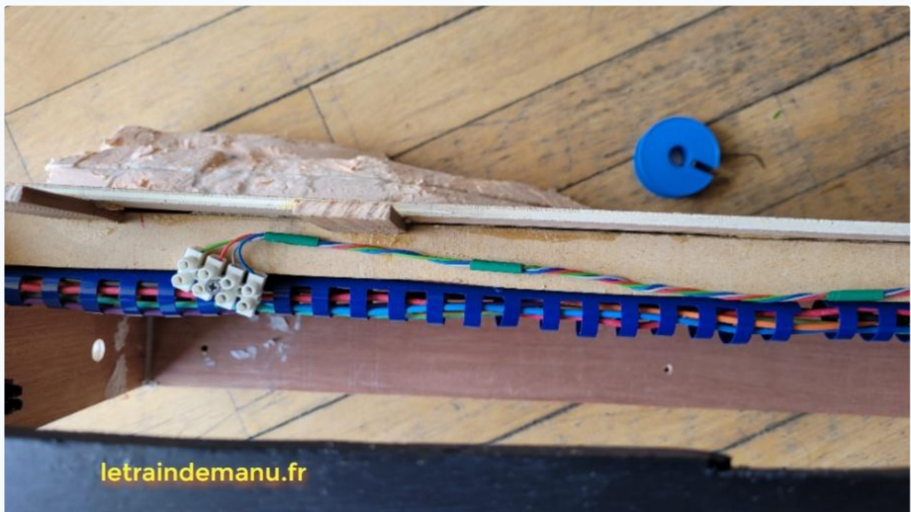
Photo 2591 : Bien câbler l'électricité de son réseau de trains miniatures. L'ordre et le repérage sont les secrets d'un réseau fonctionnel. Source : letraindemanu.fr
